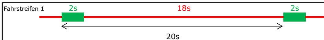
Abb. 5.6 Verteilung der Grün- und Rotzeit bei einstreifigen Anlagen mit maximaler Umlaufzeit (20 s)
